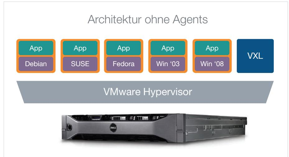
Bild 5: Die VXL Software bietet eine Agenten-freie Architektur, die jede Linux- oder Windows-Version sowie Hypervisor-Gast-OS unterstützt.
